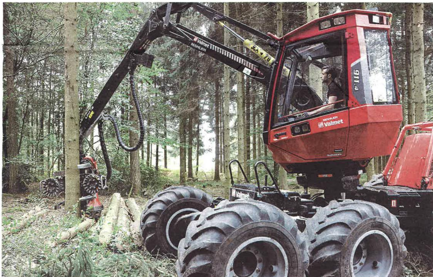
Der Vollernter arbeitet sich im Gebiet «Stutzgänter» in Siglistorf auf einer Rückegasse durch den Fichtenwald.
