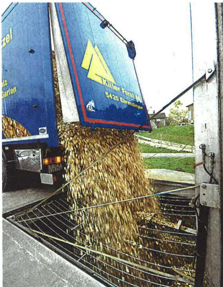
Wie heute schon in Ehrendingen werden die Holzhackschnitzel künftig auch in Bad Zurzach im Schnitzelbunker abgeladen.
