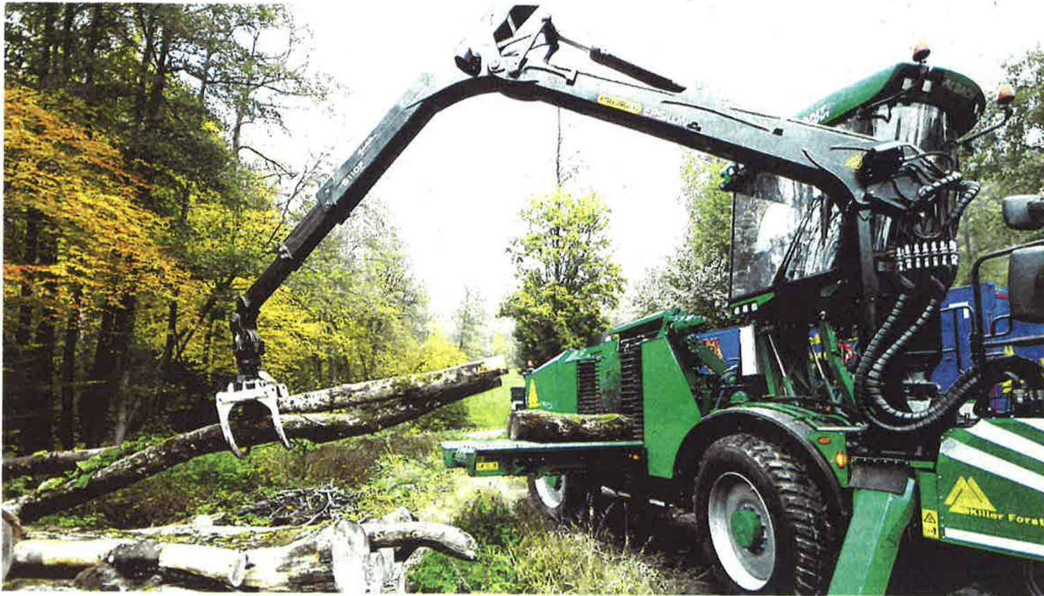
Der Hacker packt die Holzstämmen mit dem Greifarm und schiebt sie dann ins Schneidwerk.
